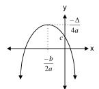
La gráfica de  $f(x) = ax^2 + bx + c$  es una parábola cóncava hacia abajo si a<0, y corta al eje **x** en dos puntos si  $\Delta$ >0.
